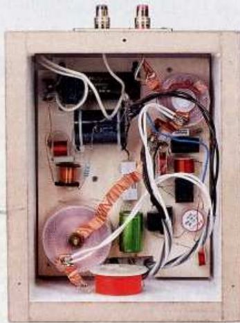
Die umfangreiche Weiche ist mit feinsten Mundorf-Bauteilen bestückt. Herr Achenbach hält jedoch eine abgespeckte Version mit einfacheren Bauteilen bereit
